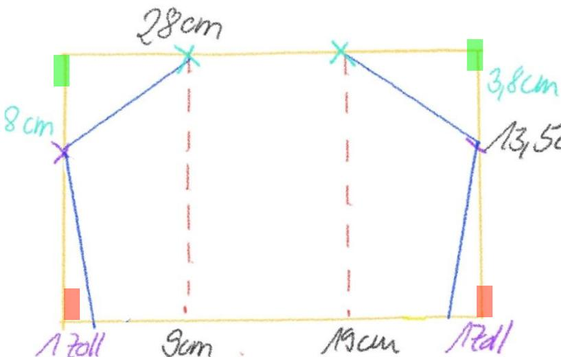
Nun die auf dem Bild grün markierte Stelle an der Schneidenut anlegen und Ecke (hellgrün gekennzeichnet) bei 3,8 cm anlegen und schneiden.
